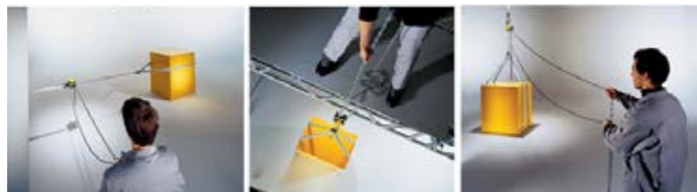
Possibilidade de trabalho com equipamento na horizontal, operador acima da talha e mantendo uma distância segura.
